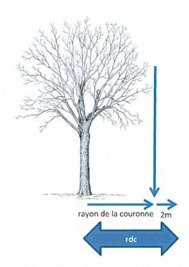
Des distances minimales de construction aux boisements hors-forêt ont été établies selon le type de construction et le type de la zone qui va être construite; elles doivent être respectées. Dans certaines circonstances, une dérogation à ces distances minimales établies peut être accordée par l'instance de décision compétence (préfecture ou commune). Les formulaires de demande de dérogation sont mis à disposition par le Service de la nature et du paysage.
